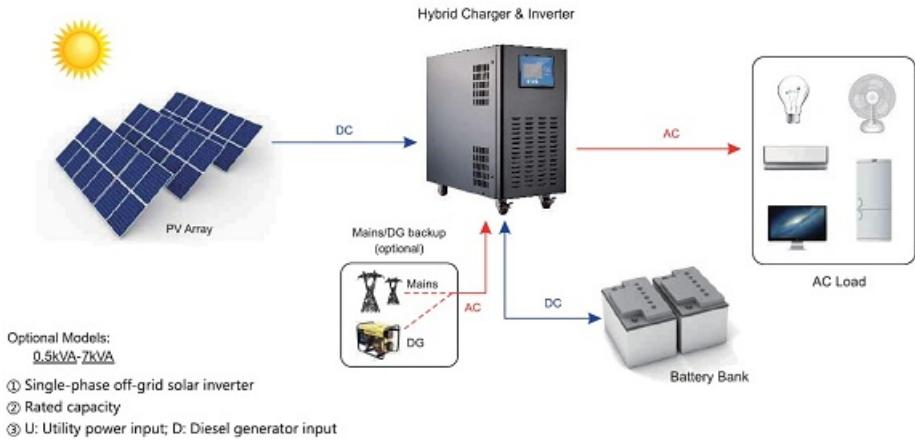
Pentru set complet la maxima putere se recomanda echiparea cu maxim 62 panouri fotovoltaice de 240W (pentru zonele extrem de umbrite unde lumina naturala trebuie exploata la maxim) si conectate la un banc de acumulatori de maxim 480AH/12vcd
