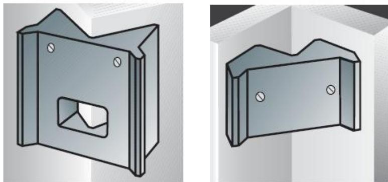
Senzorul vine cu un adaptator pentru montajul in colt.
